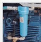
Possui separador de condensado com dreno eletrônico após o radiador de ar, fazendo com que o ar de saída possua menor quantidade de umidade
